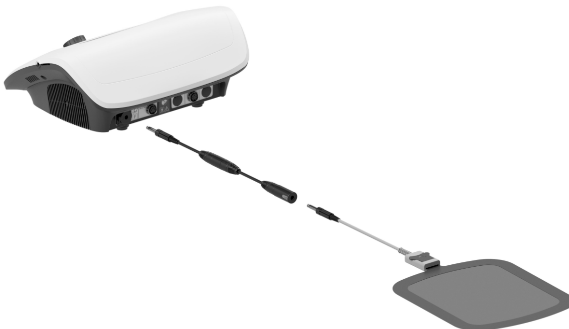
Rysunek 7.10. Podłączenie elektrody płaskiej z użyciem zrywki
